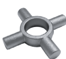
Крестовина дифференциала Номер изд.: 375-2403060 Вес: 2,1 кг Марка стали: 18ХГТ
