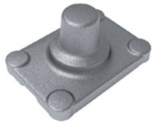
Опора Номер изд.: 1500-2919035 Вес: 4,3 кг Марка стали: 40, 35
